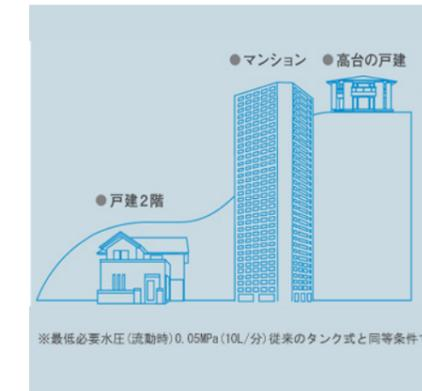
※最低必要水圧(流動時)0.05MPa(10L/分)従来のタンク式と同条件です。
